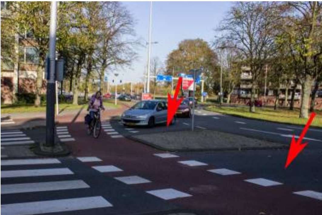
Figur 5 Tydlig väjningspliktsmarkering i rondell där även bilen får plats mellan rondellen och cykelöverfarten och behöver därför inte hindra annan trafik eller blockera cykelbanan.
